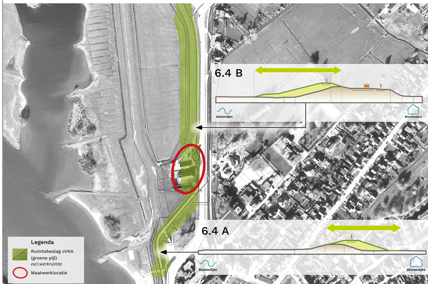
Voorkeursalternatief in bovenaanzicht en profielen van deeltraject 6.4 IJsselmuiden Frieseweg
