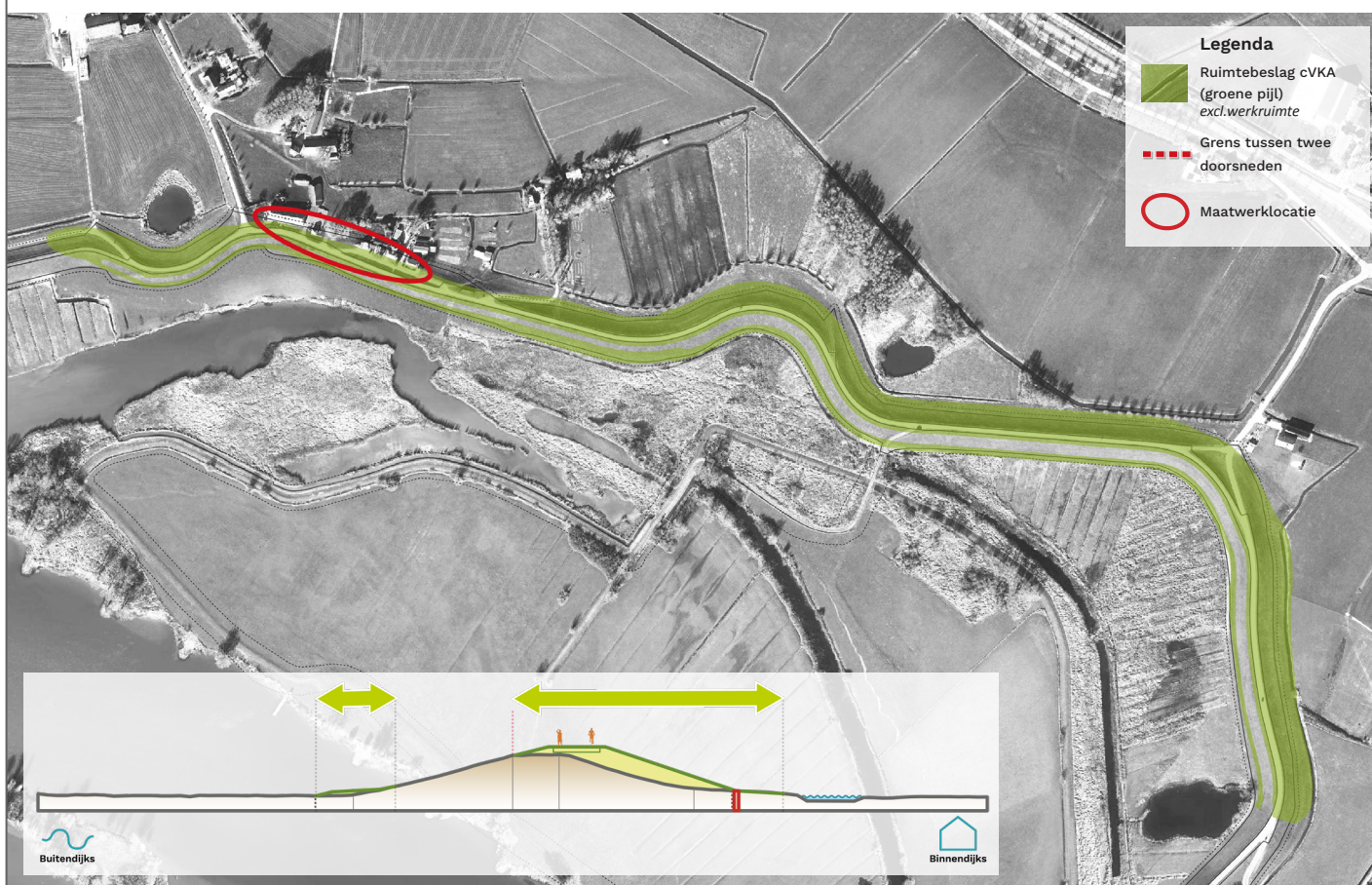
Voorkeursalternatief in bovenaanzicht en profielen van deeltraject 4 Scherenwelle
